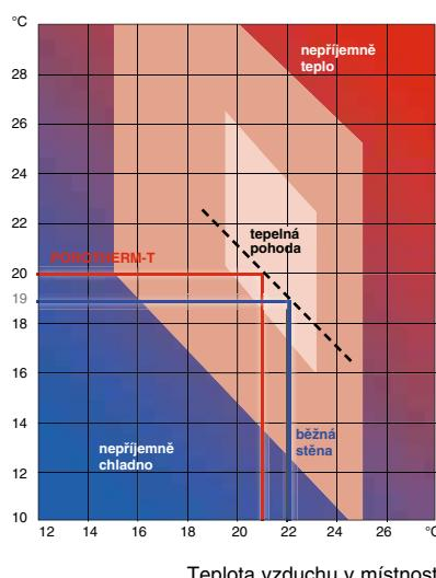
U vnější stěny z cihel **Porotherm T Profi** tloušťky 38 cm činí výpočtově rozdíl teploty vnitřního povrchu oproti teplotě vzduchu v místnosti během chladného zimního dne přibližně  $1 \text{ }^{\circ}\text{C}$ . To umožnuje pokles teploty vzduchu v místnosti o 1 až 2  $^{\circ}\text{C}$  při nadále příjemném klimatu v místnosti. Pokles teploty v místnosti o  $1 \text{ }^{\circ}\text{C}$  vede ke snížení energie na vytápění o cca 10 %.
