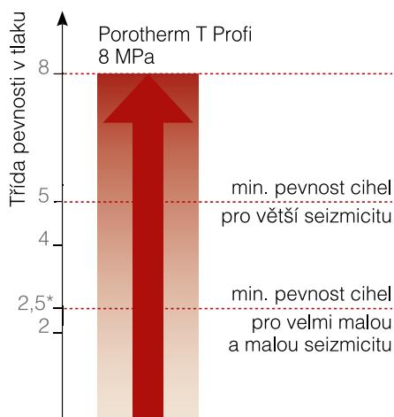
\* Od pevnosti v tlaku  $2,5 \text{ N/mm}^2$  a výše je možné použít zdicí prvky pro konstrukce odolávající účinkům zemětřesení.
