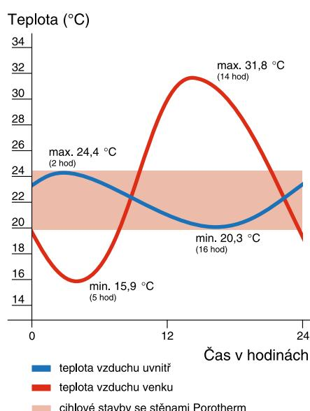
Také v případě vysokých venkovních teplot zůstává teplota obytných prostor se stěnami z cihel Porotherm T Profi relativně konstantní.
