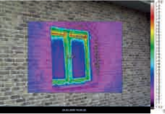
Termovizní snímek stavebního otvoru
