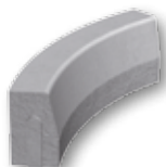
78 x 15 x 25 Silniční obrubník I oblý (vnitřní) vnitřní rádius r = 1,0 m, 8 ks/1 kruh hloubka pro zapuštění 10 cm
